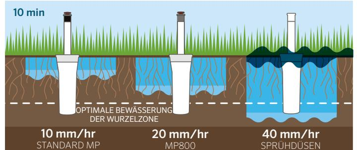
Berücksichtigen Sie bei Ihren Laufzeiten unbedingt die Niederschlagsrate. Standard MP-Rotator-Düsen geben das Wasser langsam mit 10 mm/Std. ab und ermöglichen so effiziente Bewässerung auch auf festen Böden und steilen Hängen. MP800-Düsen geben Wasser mit 20 mm/Std. für mittelschwere und feinere Böden ab. Herkömmliche Sprühdüsen geben Wasser schneller ab, als Böden es aufnehmen können. Dies kann zu Überschwemmungen und Abfließen führen.
