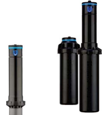
PGP-00-PRB Gesamthöhe: 22 cm Freiliegender Durchmesser: 4,5 cm Einlassgröße: ¾"
