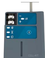
CELLKIT Mobilfunk-Modul für ICC2- Steuergeräte, Verwaltung in Centralus-Software Seite 124
