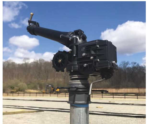
ST-1200-BR Getrieberegner Installiert
