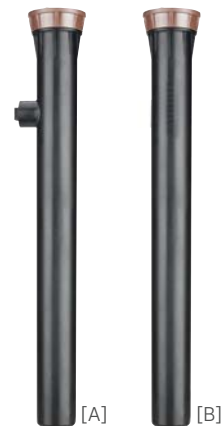
[A] PROS-12-SI-PRS30* [B] PROS-12-PRS30* Eingezogene Höhe: 41 cm Aufsteigerhöhe: 30 cm Freiliegender Durchmesser: 5,7 cm Einlassgröße: ½"
